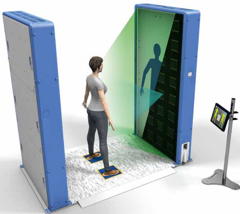
BILD 3: Multistatisches Arbeitsprinzip: Während jeweils immer nur einer der 3008 Sender eines Panels aktiv ist, empfangen sämtliche 3008 Empfangsantennen das reflektierte Signal. Da jeder Sender außerdem in schneller Folge durch 128 Frequenzen stept, bevor der nächste zu senden beginnt, fallen bei jedem Scan-Vorgang mehr als eine Milliarde (!) komplexe Messwerte pro Panel an (Betrag und Phase), und das innerhalb von nur 32 ms.
